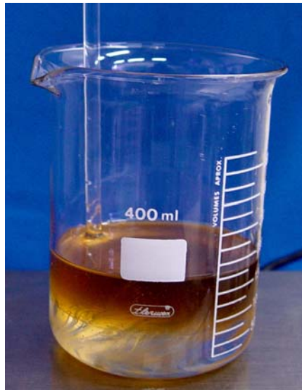
Figura 4.5 – Resina fotoelástica vertida em um Becker, sendo espalada com um bastão de vidro
